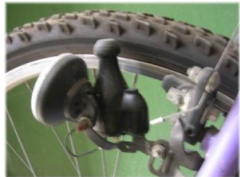
Aplicación de la rueda de fricción: La dinamo.
